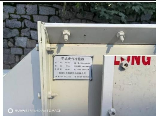
尾气处理系统（含尘废气）
