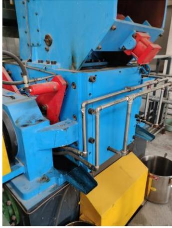
密炼室、转子、加料压料机构、卸料装置及注油器
